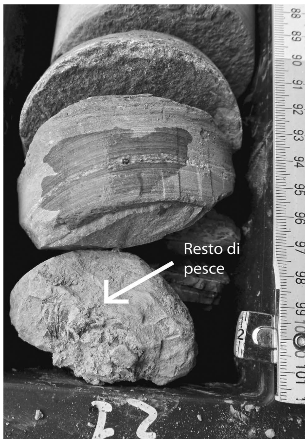
Fig. 6 – Dettaglio delle laminitie marnoso-argillose con resti di pesce (freccia) alla profondità di -21 metri.
